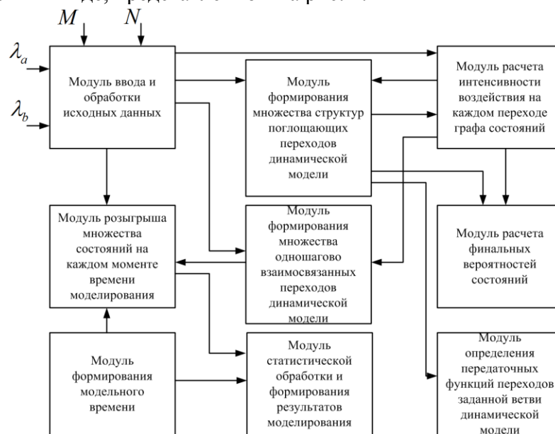
Рис. 2. Структура взаимосвязанных модулей компьютерной модели
