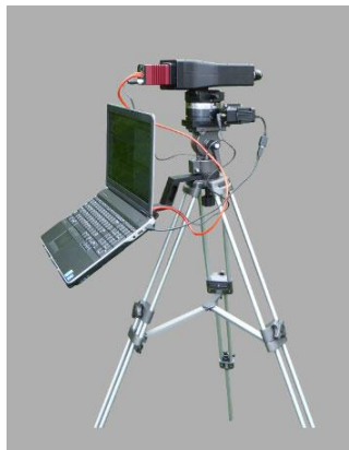
Рис. 3. Внешний вид информационной части МСВС за процессом заживления ран: 1 — система из видео и тепловизионных камер, 2 — ноутбук, 3 — управляемый штатив, 4 — система подсветки
